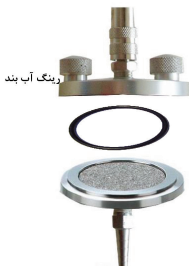
شکل ۴- جاگذاری صافی 0.45 \mu\text{m} میکرومتر در محفظه فیلتر
