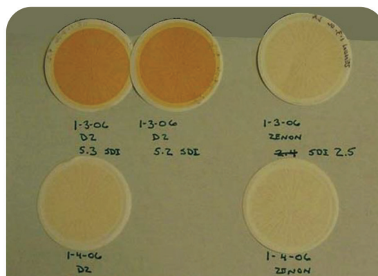
شکل ۶- نمونه صافی‌های ۰٫۴۵ میکرومتر بعد از آزمایش SDI
